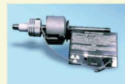
Rilevatore a cattura elettronica
